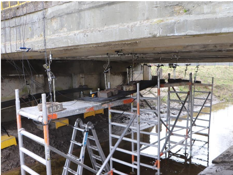
13 pav. Statiniams įlinkiams matuoti naudoti skaitmeniniai įlinkiomačiai (kairėje) ir jų sąsaja su imtuvu bei personaliniu kompiuteriu (dešinėje)
