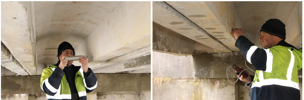
8 pav. Tilto laikančiųjų konstrukcijų betono gniuždomojo stiprio tyrimai neardančiuoju būdu (kairėje) ir plyšių pločių matavimas (dešinėje)
