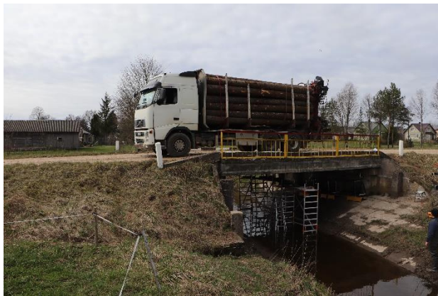
11 pav. Tilto statinio apkrovimo schemos perdangos plokščių maksimaliems lenkimo momentams ir įlinkiams gauti (viršuje) ir tilto statinio apkrovimo miškovėžio bandomąja apkrova bendri vaizdai (apačioje)
