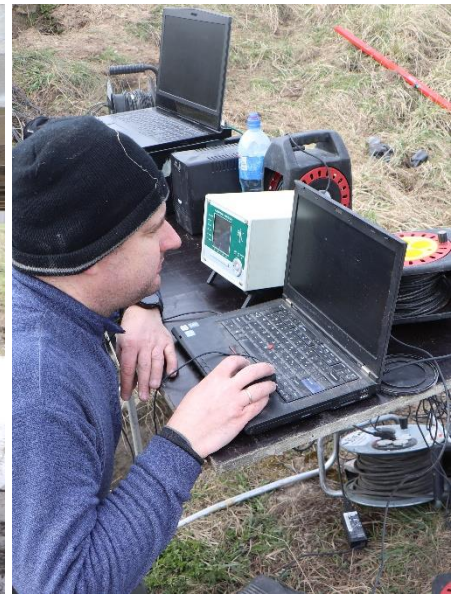
13 pav. Statiniams įlinkiams matuoti naudoti skaitmeniniai įlinkiomačiai (kairėje) ir jų sąsaja su imtuvu bei personaliniu kompiuteriu (dešinėje)
